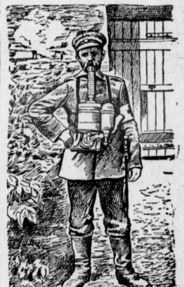
Sauerstoffapparat für Sanitätsmannschaften, der gegen die Wirkung giftiger Gase zur Verwendung gelangt.
