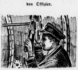
Während der Beobachtung bedient der Offizier den Hebel, um dem Auge des Bootes eine veränderte Stellung zu geben. Dicht dabei sind alle die Geräte, die die Leitung des Bootes und seiner Maschinen (samt der Verbindung mit der Mannschaft) gestatten.
