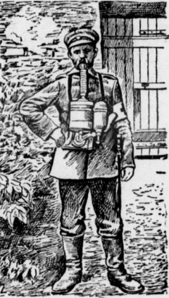
Sauerstoffapparat für Sanitätsmannschaften, der gegen die Wirkung giftiger Gase zur Verwendung gelangt.
