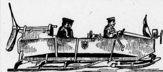
Neuer Motorschlitten, welcher durch Propellerantrieb mit einer Geschwindigkeit von über 100 Kilometer fährt.
