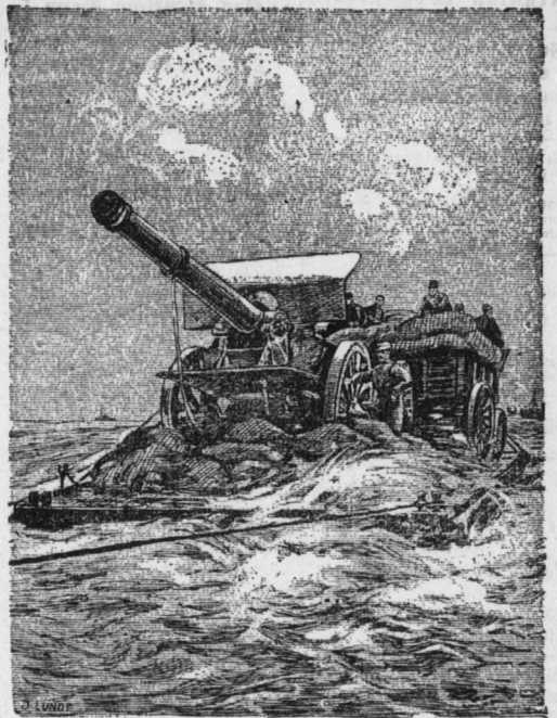
Das besonders für diesen Zweck erbaute Ponton wurde von einem Schleppdampfer langsam zur Landungsstelle gezogen. Die Sandbänke dienen zum Verstellen des Pontons auf die Entende des Risopotome. Das Geschütz selbst war mit schweren Ketten am Pontongerüst verankert. Das kleine Ponton getriebene schnelle Landen.
