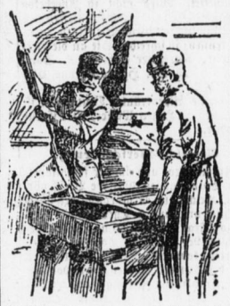
Einfüllen des geschmolzenen Goldes in die Form.
