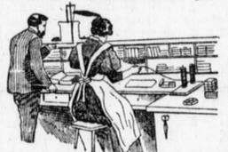
Ist das Gold in der Form schließlich in der nötigen Dünne geschlagen, so wird dasselbe meist durch Frauenspersonen ausgelegt und auf einem mit einem Stahlblech überzogenen Brettchen mit zwei nebeneinander stehenden verstellbaren Messern in Quadratblätter in der Größe von 50 bis 130 Millimeter geschnitten. Was den beim Schneiden des Goldes sich ergebenden Abfall anbelangt, so wird derselbe sorgfältig gesammelt und wieder eingeschmolzen; er macht dann noch einmal die erzählte Prozedur durch.
