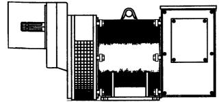
10 TO 150 KW 1800 RPM BRUSHLESS TRACTOR DRIVEN GENERATORS
